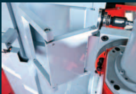
Odklápěcí zařízení. Vertikální hlava upevněná na odklápěcí zařízení. Kontrola koncovým spínačem.
