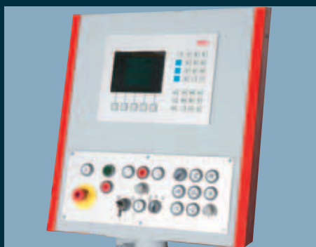
Ovládací panel. Ovládací panel s přehlednou klávesnicí usnadňuje obsluhu. Standardní vybavení: Číslíková indikace EMCO ve 3 osách X,Y,Z.
