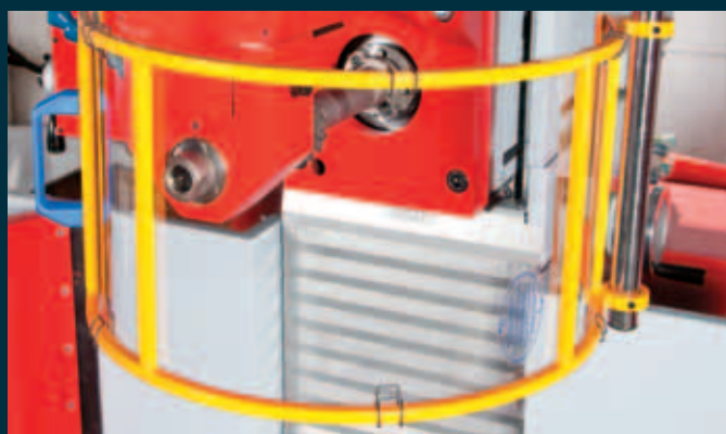
Kryt pracovního prostoru. Kryt instalovaný na kloubovém rameni zvyšuje bezpečnost obsluhy.
