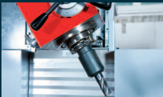
Natáčecí vertikální frézovací hlava. Díky natáčení vertikální frézovací hlavy lze snadno provádět i náročné obrábění. Otočná v rozsahu +/- 90°
