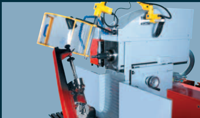
Dělicí přístroj. Dělicí přístroj s koníkem, upnutý na vertikální upínací ploše, umožňuje také výrobu komplikovaných částí.
