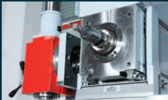
Mnohostrannost. Horizontální frézování nabízí mnohostranné možnosti obrábění. Po odklopení vertikální svíslé hlavy lze obrábět vodorovným vřetenem.
