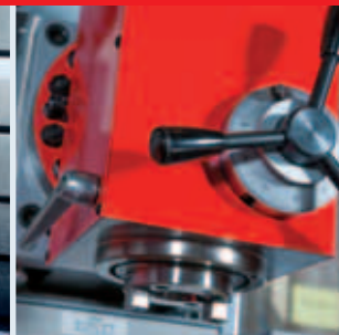
Vertikální frézovací hlava s upínáním SK 40 podle DIN 69871 a zdvihem pinoly 80 mm.
