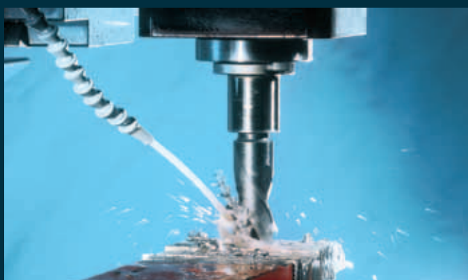
Vertikální svíslá hlava. Vrtání velkých průměrů vertikálním vřetenem. Zdvih pinoly až 80 mm.
