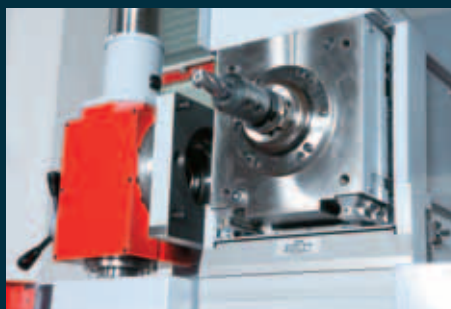
Přestavení na vodorovné frézování. Vodorovné frézovací vřeteno s upínáním SK 40 podle DIN 69871.
