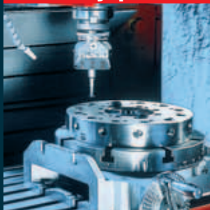
Opracování revolverové desky vyvrtávací hlavičkou.
