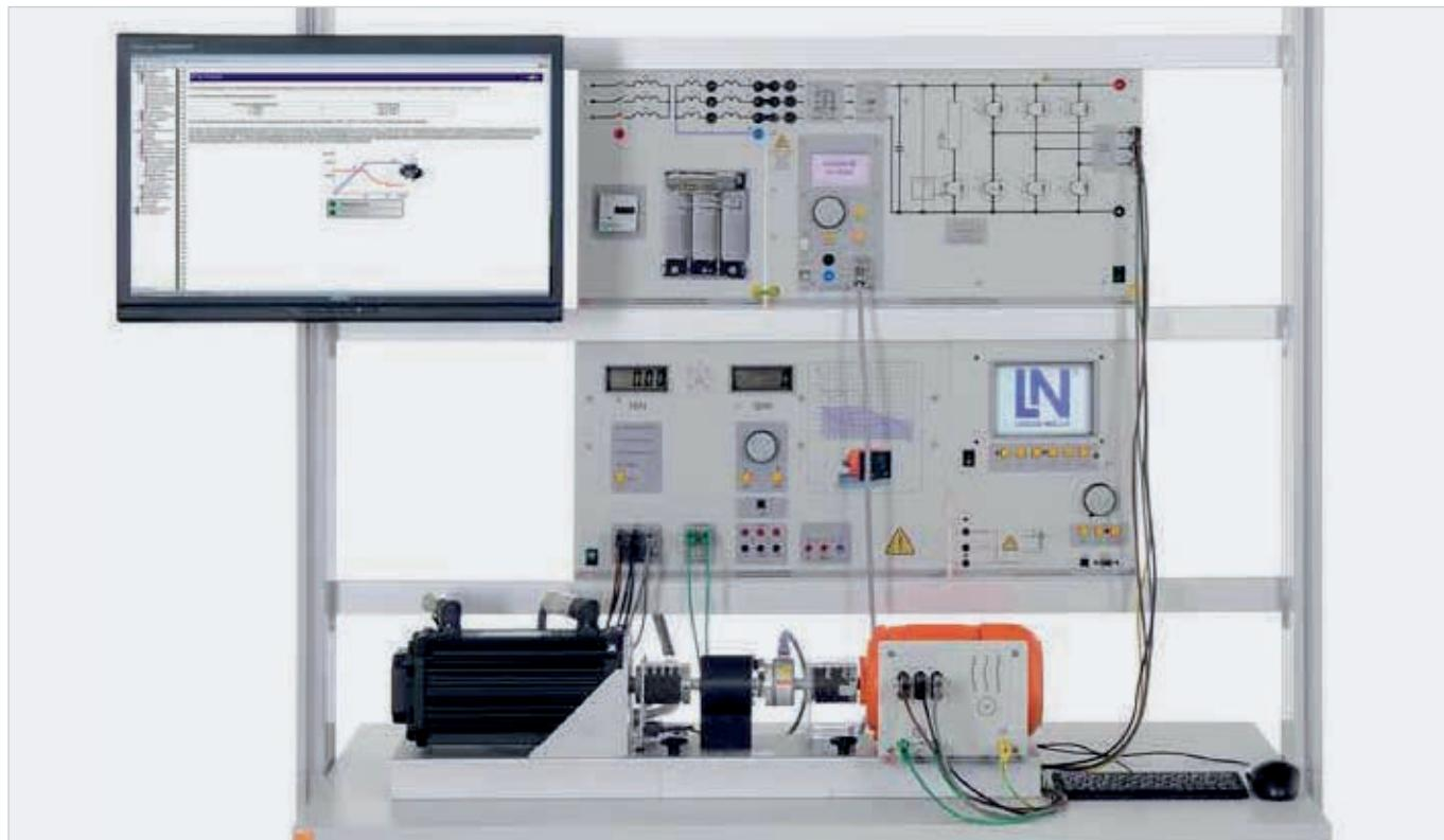
Vzdelávací systém „Vektorová regulácia asynchronných strojov s Matlab®/Simulink® a servobzdzou“
