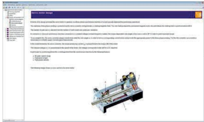
Konštrukcia synchronného servomotoru v kurze ILA „Servopohony“
