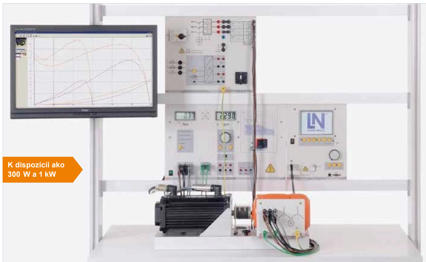
Príklad zapojenia „Trojfázový stroj s pólovým prepínaním a dvomi oddelenými vinutiami EEM 4.3“
