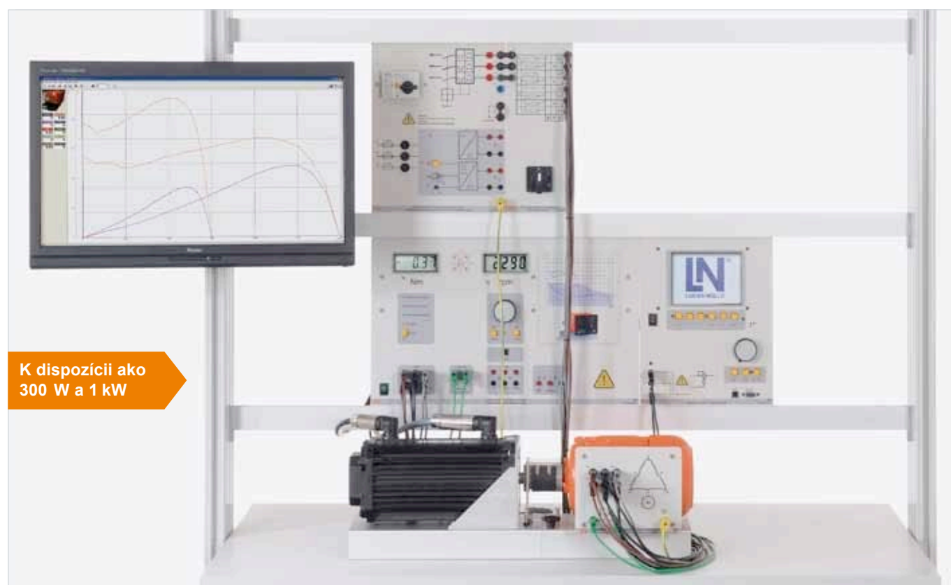
Príklad zapojenia „Trojfázový stroj s prepínateľnými pólmi Dahlanderovo zapojenie EEM 4.2“
