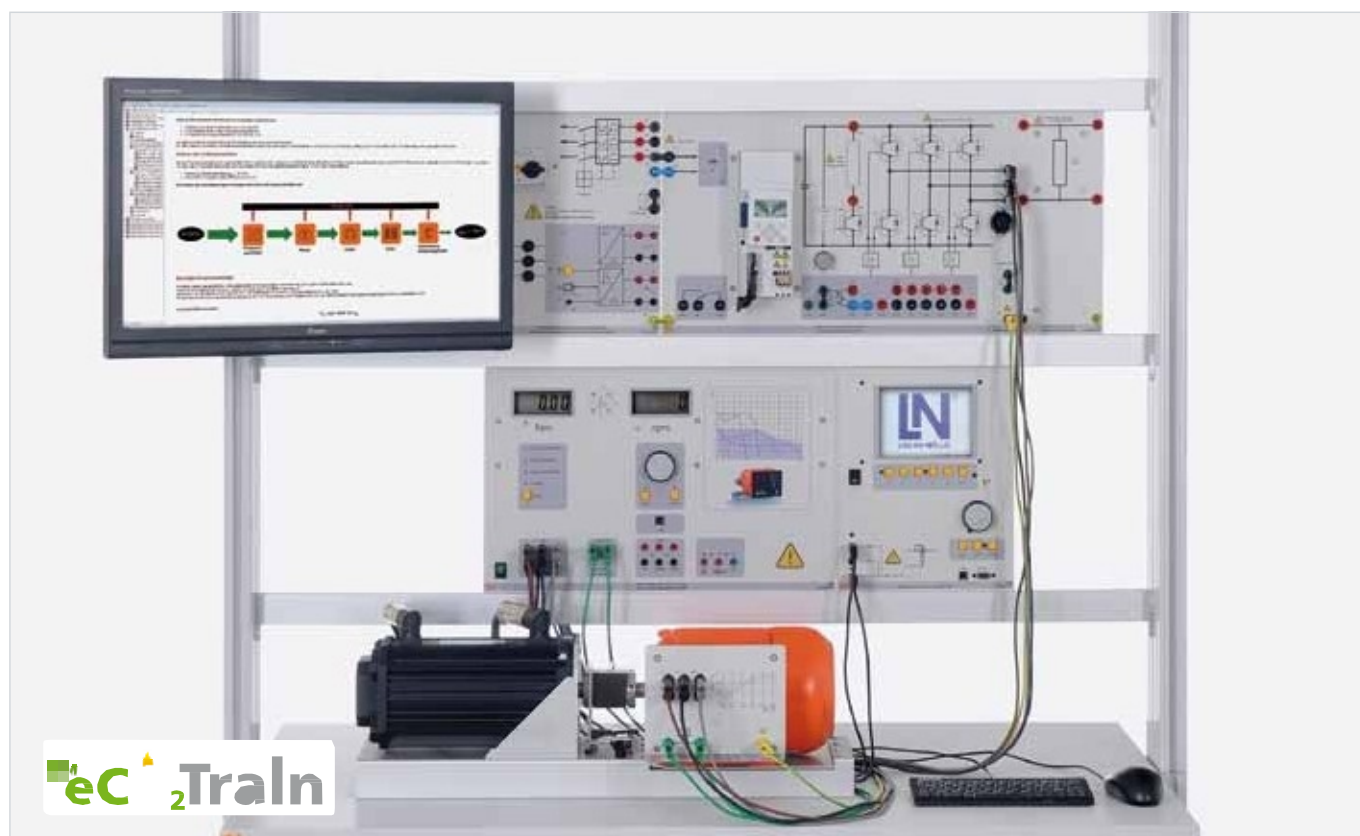
Zariadenie „Energeticky efektívne pohony s frekvenčným meničmi“ obsahuje vysokoefektívny motor, frekvenčný menič a servobrzdú EEM11.3
