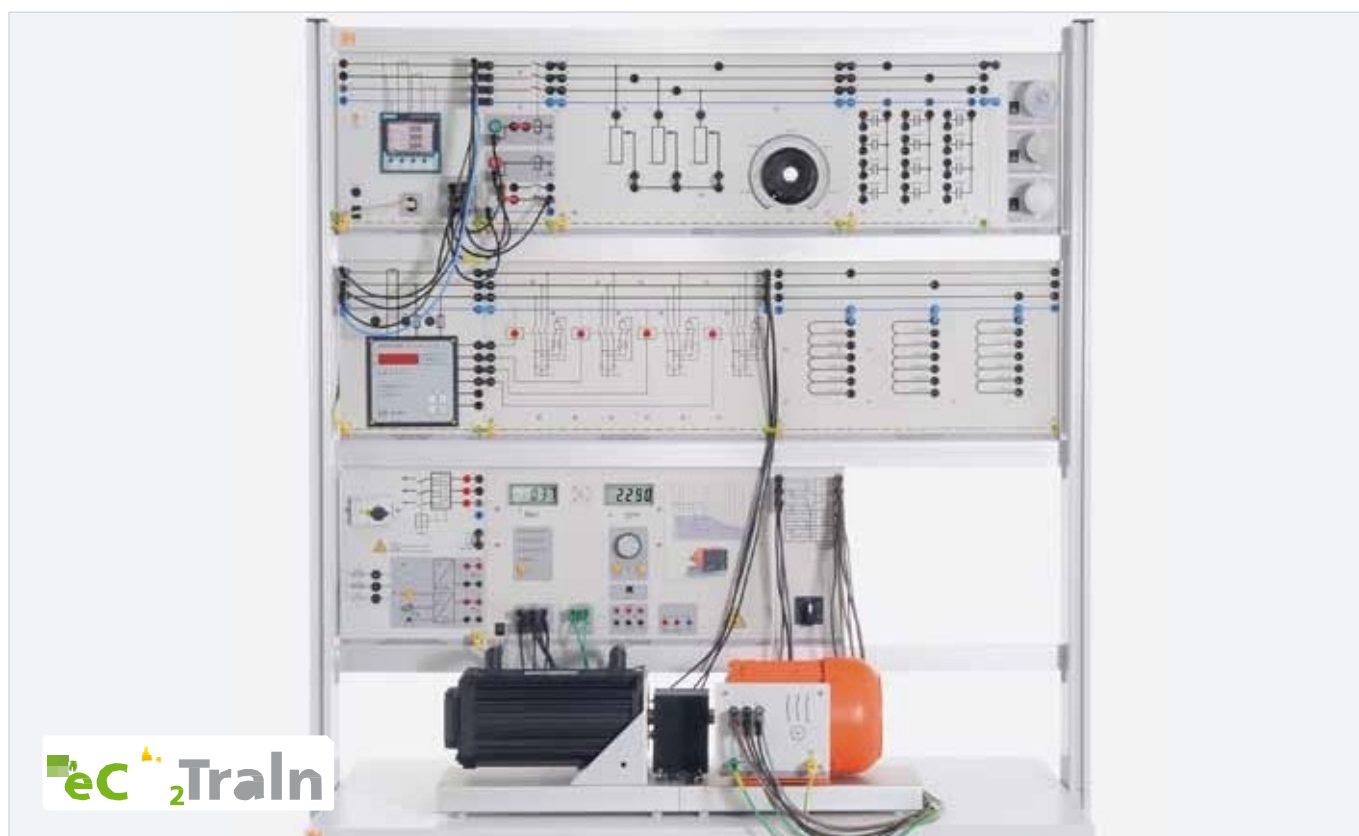
Príklad zapojenia „Smart Grid: Manažment energie ESG 1.2“
