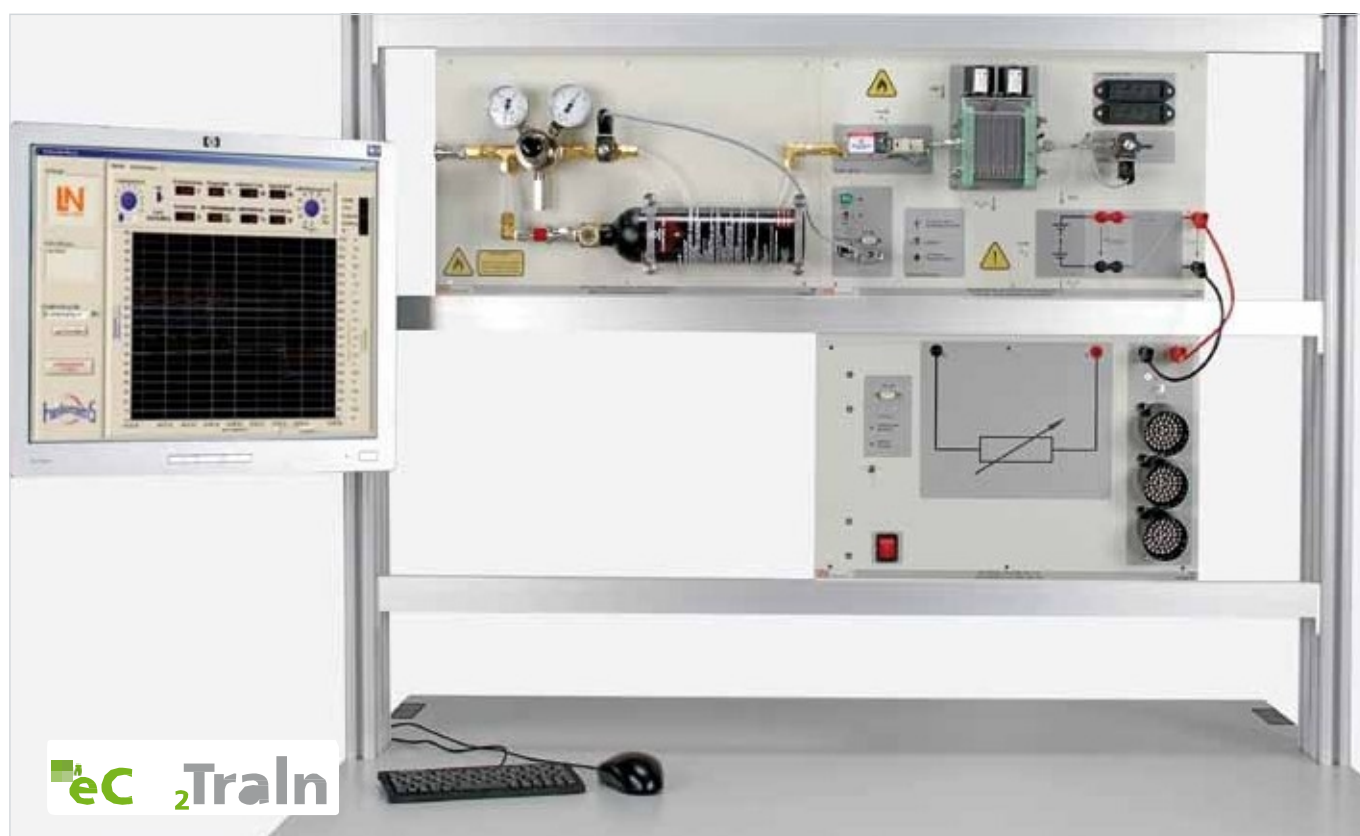
Príklad zapojenia „50-VA-palivový článok so spotrebičmi EHY 1“
