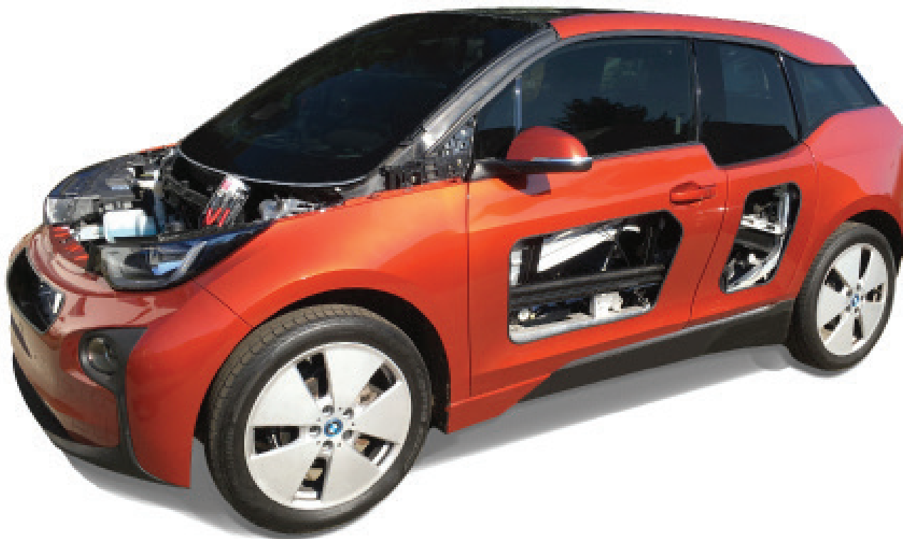
Príklad: Rez vozidla BMW i3
